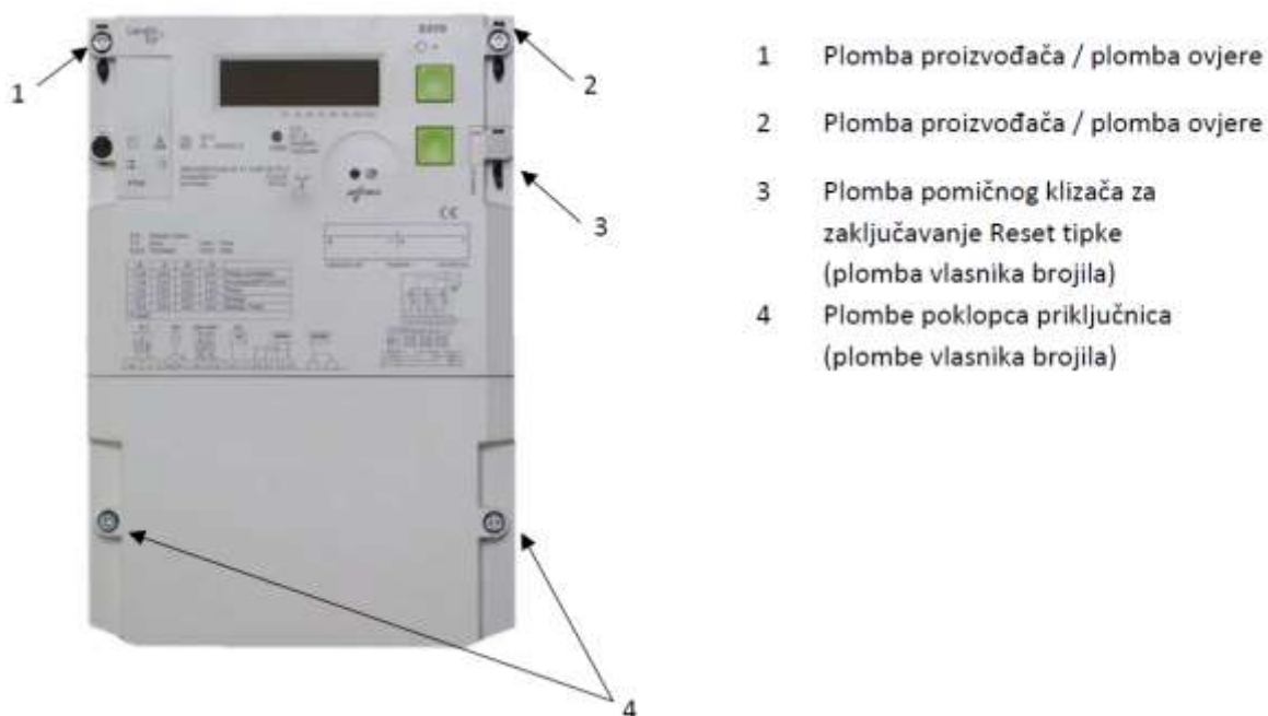
Slika 1. Fotografija brojila s označenim mjestima ovjere
